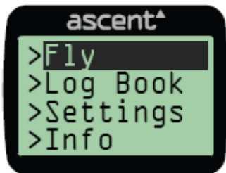
Menú Principal - Esta pantalla tiene 4 opciones: FLY-Vuelo, LOG BOOK-Libro de Vuelos, SETTINGS-Ajustes e INFO-Información. Utilice los botones ▲ ▼ para escoger la función y pulse el botón ► para confirmar la selección.
